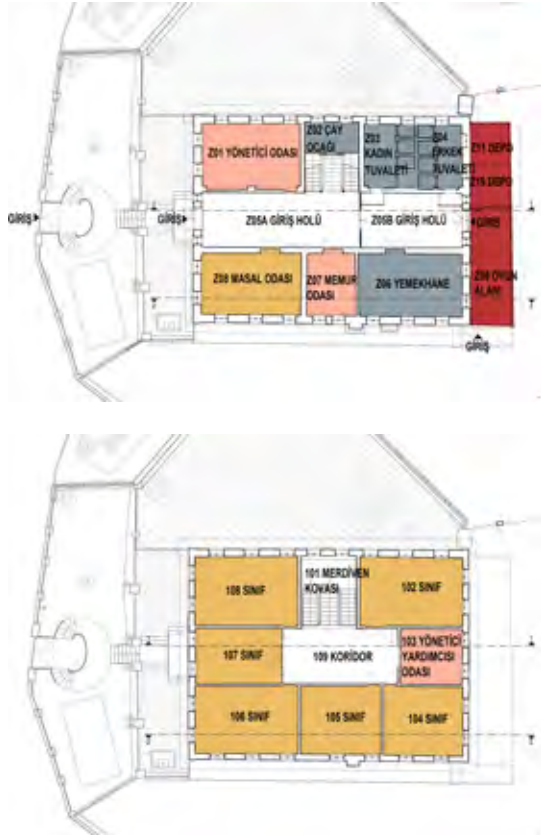
Resim 3-4. Zemin kat ve birinci kat planı (pembe, idari birimleri; mavi, ıslak hacimleri; sarı, sınıfları; kırmızı, ek yapıyı göstermektedir).
