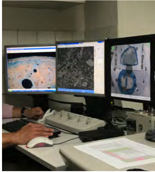
Şekil 5. Tarihi yapı malzemeleri incelemelerinde taramalı elektron mikroskobu uygulamaları.
