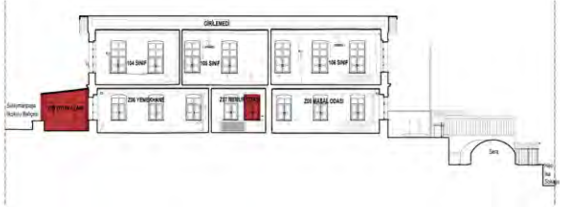
Resim 14. Kuzey-güney (2-2) kesiti, işaretli alanlar ek yapıyı ve sonradan açılan pencere açıklığını göstermektedir.
