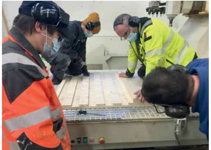
Resim 7. Kırılğıçkuyruğu ahşap panel eleman imalatı, Lapland Meslek Yüksek Okulu, Kemi, Finlandiya
