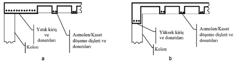
Resim 1. a. Asmolen döşemede yatık kiriş, b. Yüksek - tablalı kiriş
