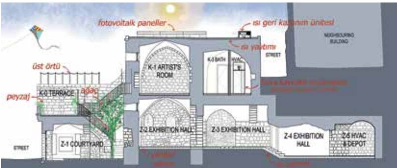
Resim 3. Tamirevi kesiti üzerinde enerji verimli çözümler.
