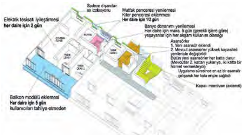
Resim 2. Cité du Grand Parc , yapıda gerçekleştirilen iyileştirmeler ( https://www.lacatonvassal.com )
