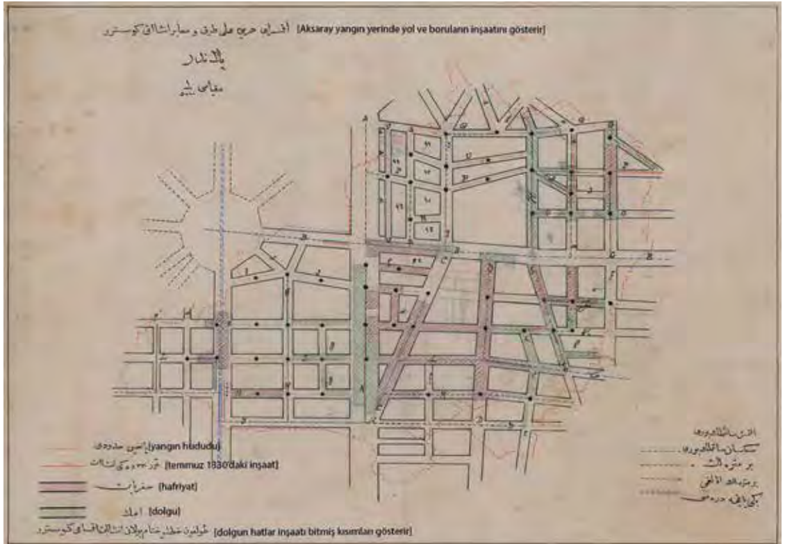
Resim 18. 1912 Aksaray yangın yeri planlamasına göre yeni yol ağında, tamamlanan hafriyat ve dolgu inşaatı yanı sıra, döşenen lağım borularını gösteren çizim (IAK. Hrt-005322-Temmuz 1330[1914]).
