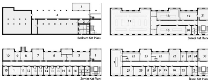
Resim 4a. Botanik Enstitüsü şematik plan çizimi (Planlar Ayverdi’ye ait ‘Üniversite Hayvanat ve Nebatat Enstitüleri’ isimli plan çizimlerinden yararlanılarak yazar tarafından hazırlanmıştır.) 1. Depo, 2. Lavabo, 3. Camlı bitki yetiştirme yeri, 4. Kışık bahçe, 5. Fizyoloji laboratuvarı, 6. Kimya laboratuvarı, 7. Bakterioloji laboratuvarı, 8. Sterilizasyon, 9. Doktoran, 10. Atölye, 11. Sakı odası, 12. Temizleme odası, 13. Karanlık oda, 14. Alkol deposu, 15. Alet-malzeme odası, 16. Kap yıkama odası, 17. P.C.N. salonu, 18. Lisans tatbikat salonu, 19. Farmakognozi, 20. Parafin odası, 21. Hazırlık odası, 22. Vorstans laboratuvarı, 23. Vorstans odası, 24. Asistan odası, 25. Doçent odası, 26. Doçentlere ait laboratuvar, 27. Etüt odası, 28. Kütüphane, 29. Fotoğraf odası, 30. Resim odası.
